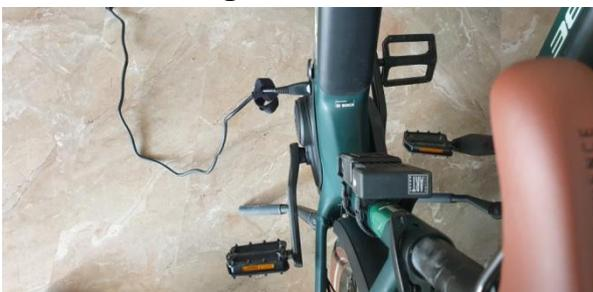
Im Bild das Ladekabel am Fahrradmotor
